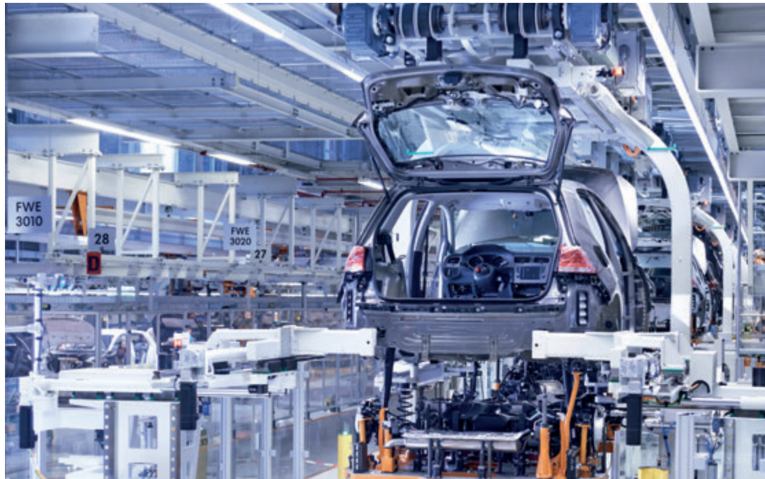
Linea di produzione automobilistica, stazione del 'mariage' (Courtesy Remech Systemtechnik).
