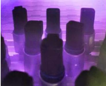
SUCO ora offre pressostati e trasmettitori puliti al plasma nei livelli di purezza "senza olio e grassi" adatti ad applicazioni con ossigeno e LABS-frei/PWIS-free per le verniciature.
